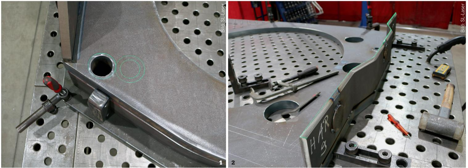
1 Einfache Laserprojektion zur Ausrichtung von Anbauteilen am Werkstück.
