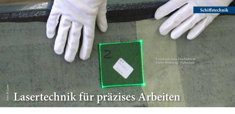
Laserprojektionssysteme der Firma SL Laser werden im Schiffbau für unterschiedliche Anwendungen genutzt, etwa zum Positionieren von Halterungen oder Kabelwegen. Ein manuelles Messen ist nicht mehr nötig
