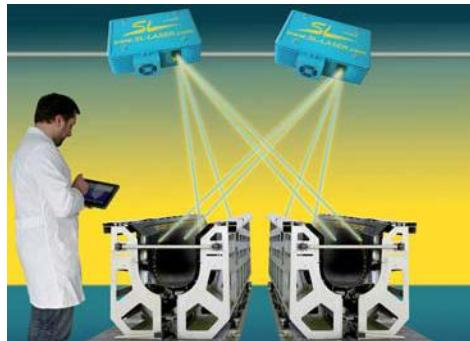
Holen Sie das Optimum aus Ihrer Investition, indem Sie mit einem Projektionssystem auf mehrere Formen zugleich projizieren. SL-3D bietet hierzu serienmäßig eine leistungsfähige Funktion zur flexiblen Gestaltung der Zuordnung eines oder mehrerer Projektoren zu verschiedenen Formen an einem Arbeitsplatz. Die Steuerung und Dokumentation der Arbeitsabläufe erfolgt unabhängig für jede einzelne Form. Wahlweise auch mit einem Tablet PC steuerbar.
