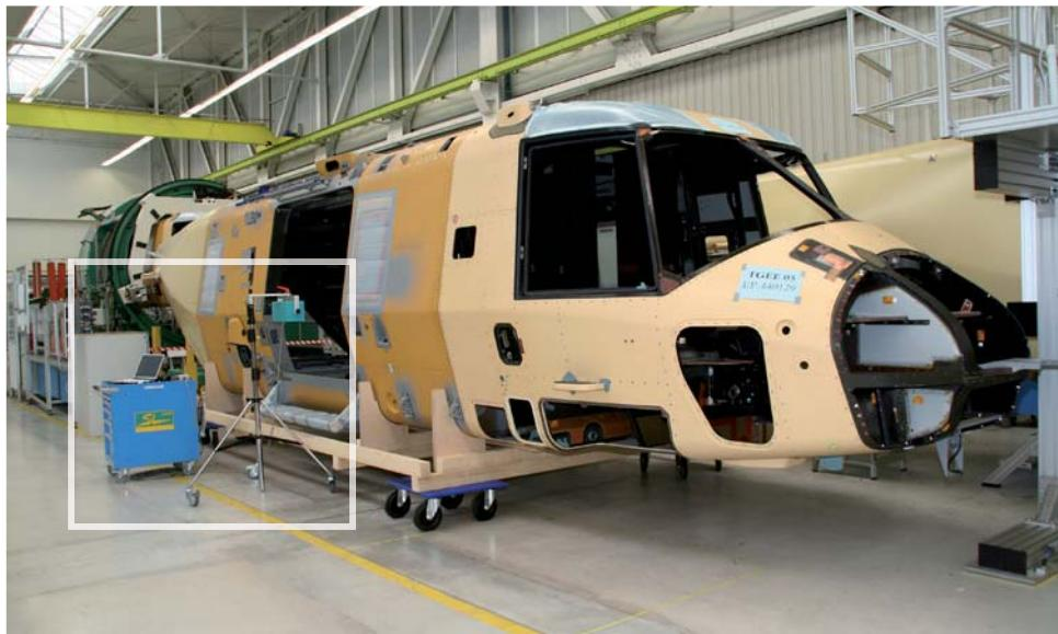
Mobiles System für die Projektion der Bauteile
