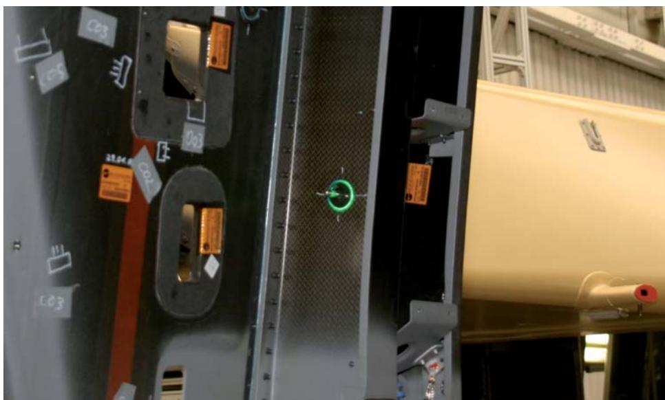
Projektion für die Positionierung eines Bauteils
